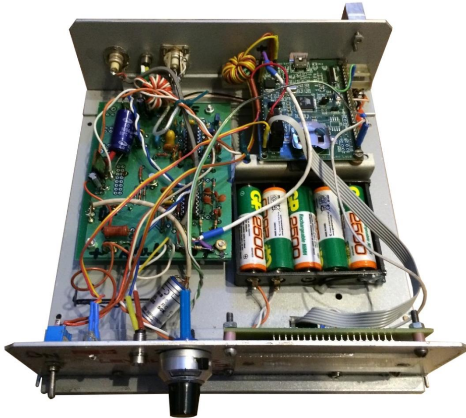
Rys. 6.25. Moduł cyfrowej obróbki sygnału EA zaprojektowany w Politechnice Morskiej w Szczecinie (opracowanie własne)
