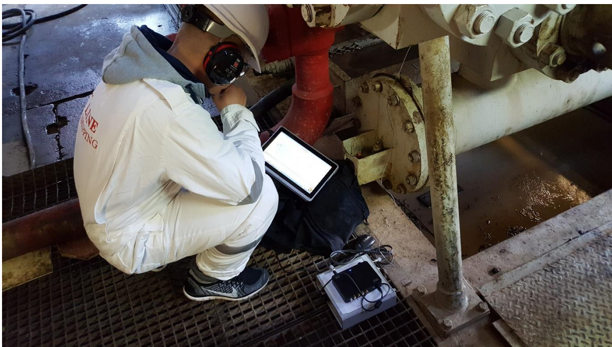
Rys. 6.10. Pomiar sygnału na pompie płuczkowej w warunkach rzeczywistych (opracowanie własne)
