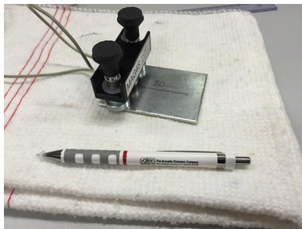
Rys. 6.28. Ołówek firmy Vallen do wzorcowania metodą Hsu-Nilsena (badania własne)
