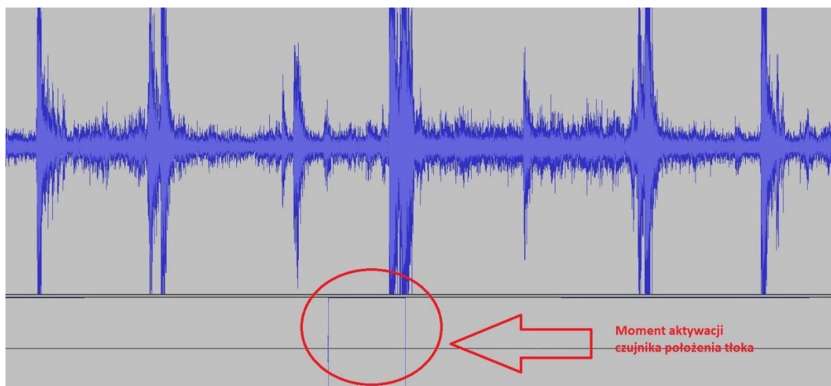
Rys. 6.23. Sygnały pochodzące z czujnika EA oraz znacznik położenia tłoka, pochodzenie z rejestratorów emisji akustycznej (opracowanie własne)
