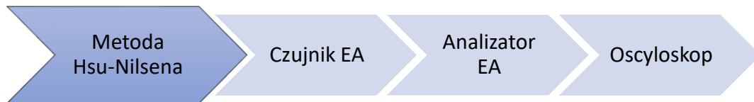
Rys. 6.27. Schemat układu toru pomiarowego stosowanego w czasie wzorcowania czujnika EA (opracowanie własne)
