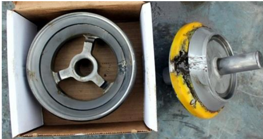
Rys. 3.20. Erozyjne niszczenie gniazda oraz wkładki elastomerowej (opracowanie własne)
