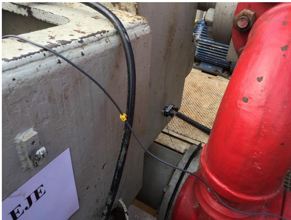
Rys. 6.14. Czujnika EA zamocowany na bloku zaworowym (opracowanie własne)
