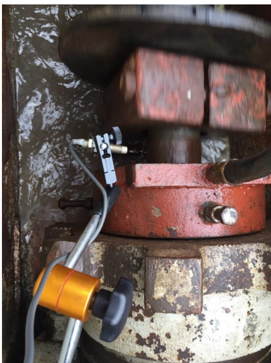
Rys. 6.22. Pomiar położenia tłoka w trakcie pracy – czujnik indukcyjny zamontowany na elemencie badanym (opracowanie własne)
